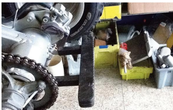
Figura 4 - Boccola limitatrice del condotto di aspirazione per la Categoria Pulcini
