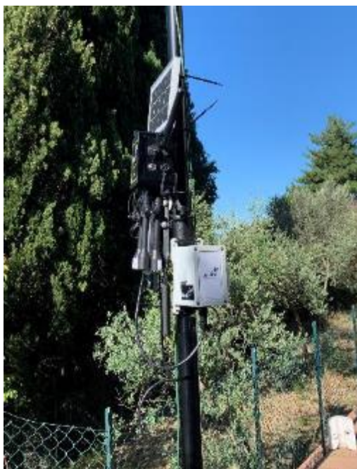
Figura 4: Esempio di installazione di una centralina Libelium equipaggiata con sensori e pannello solare
